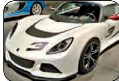
competizione con sospensioni a quadrilateri deformabili, è stato montato il propulsore finora equipaggiato solo sulla sorella maggiore Evora. Il 3,5 Litri con compressore volumetrico Harrop-Eaton è capace di erogare 350cv e 400Nm di coppia massima. La nuova 'inglesina' spinge fino a 275km/h e scatta da 0 a 100km/h in soli 3,8 secondi. Il peso totale passa dai 900kg del modello 2011 a 1080kg, per la prima
